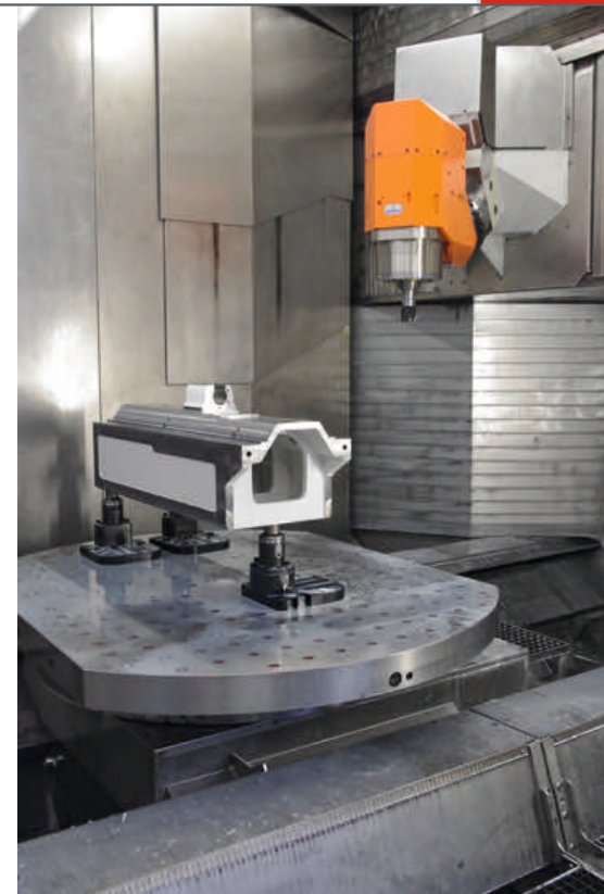
2 Beim Bearbeiten von Maschinenschlitten sind Genauigkeiten kleiner 10 µm in Ebenheit, Parallelität und Winkligkeit aller Führungsbahnen und Stirnflächen gefordert >>>
