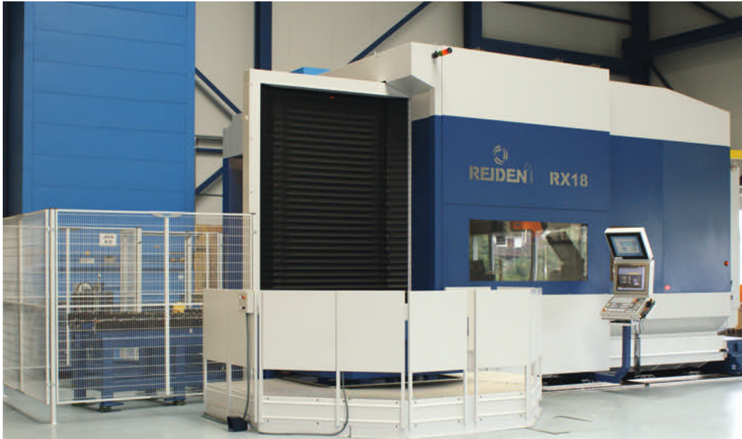
1 Die Reiden RX18: Im großen Arbeitsraum des 5-Achs-BAZ lassen sich voluminöse Bauteile von fünf Seiten problemlos bearbeiten
