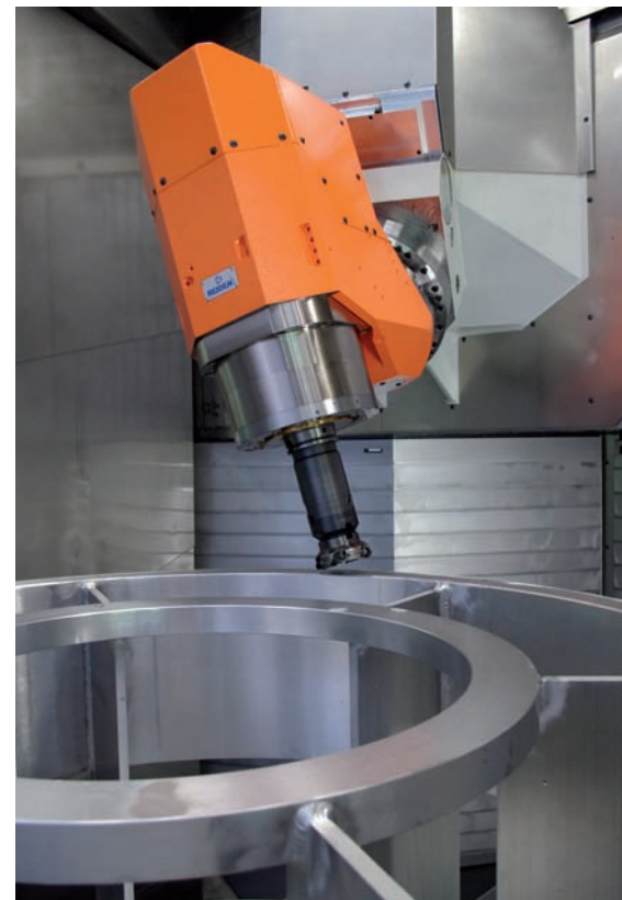
3 Für hohe Zerspanraten: Mit 300 Nm Drehmoment (100 Prozent ED) ermöglicht die Hauptspindel das Schruffräsen mit großen Werkzeugdurchmessern
