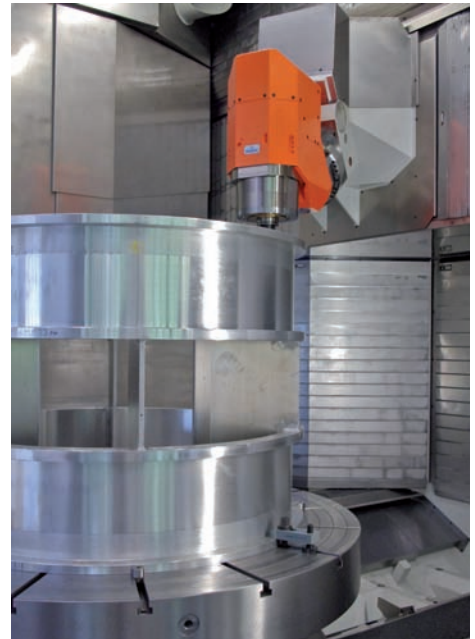
5 Aufs Drehen ausgelegt: stabiler, direkt angetriebener Drehtisch mit 1800 mm Durchmesser, integriert im großen, kollisionsfreien Arbeitsraum des 5-achsigen Bearbeitungszentrums
