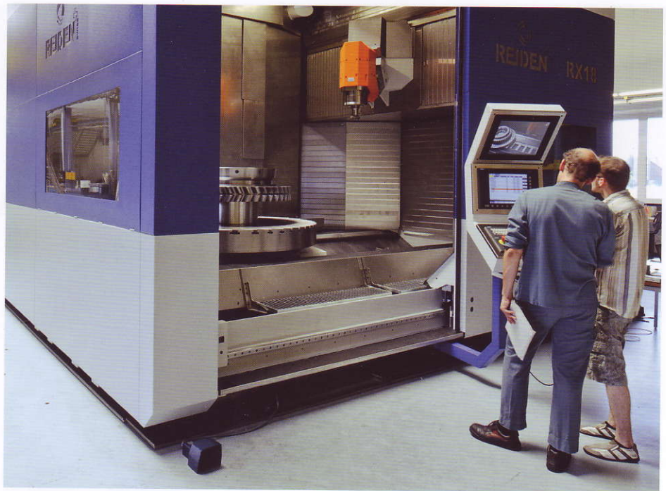
Dank dem kombinierten Fräs- und Drehzentrum müssen schwere Werkstücke, die präzise bearbeitet werden – zum Beispiel ein Zahnrad – nicht mehrmals eingespannt werden.
