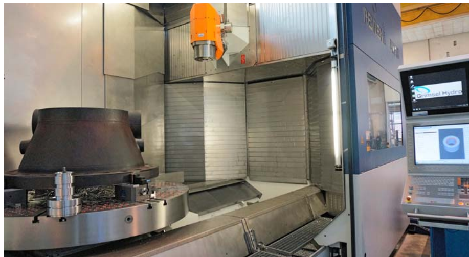
Grosszünftig und doch kompakt wurde die RX18 gebaut. Beachtenswert ist zum Beispiel der vertikale Verfahrweg (Z-Achse) von 1610 mm.
